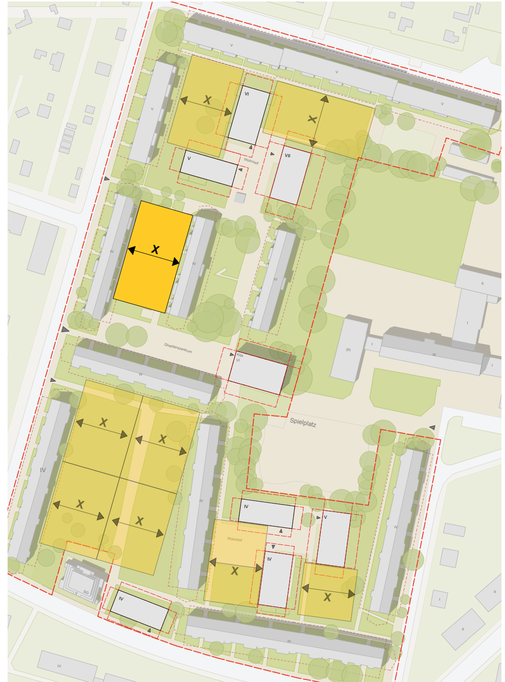
Abstände im Grünraum zwischen Bestand und Neubau
